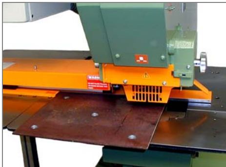
Auflagetisch komplett mit steckbarem Vorderteil für die Verarbeitung von Blechen
