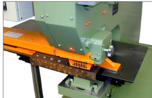
Auflagetisch ohne Vorderteil für Stanzungen in Winkelstahl
